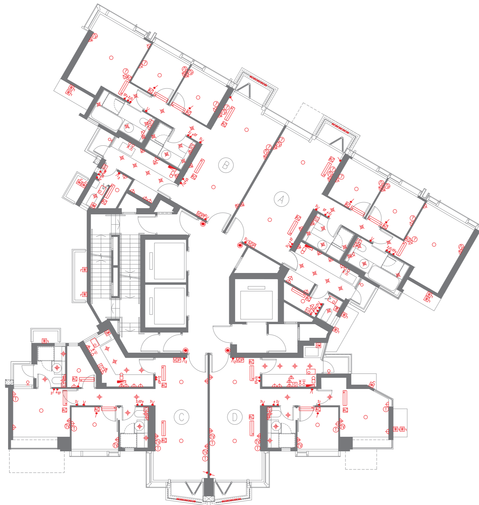
Mechanical & Electrical Provisions Plan 機電裝置平面圖
